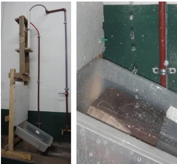
Fig. 3: Realización del ensayo erosión por caída de agua SEAT
