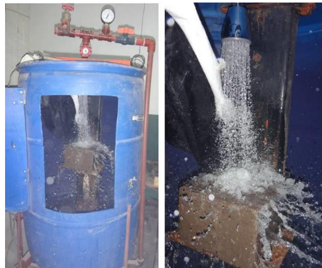
Fig. 4: Ensayo de erosión por caída de agua SEAT en progreso
