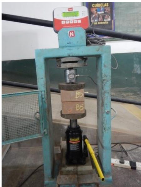
Fig. 1. Ensayo de resistencia a compresión simple
