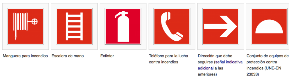
Ilustración 18. Señalización de socorro
