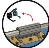
FUNCIONAMIENTO POR RESORTE DE TORSIÓN
