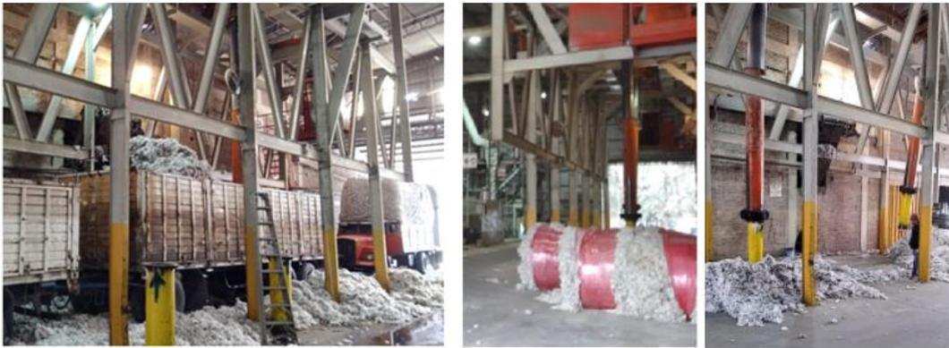
Fotografía 1.1 – Succión directa del algodón en bruto desde los acoplados y rollos de algodón.
