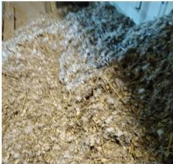
Fotografía 2.1 – Materias extrañas extraídas del algodón en bruto en las primeras máquinas de limpieza.
