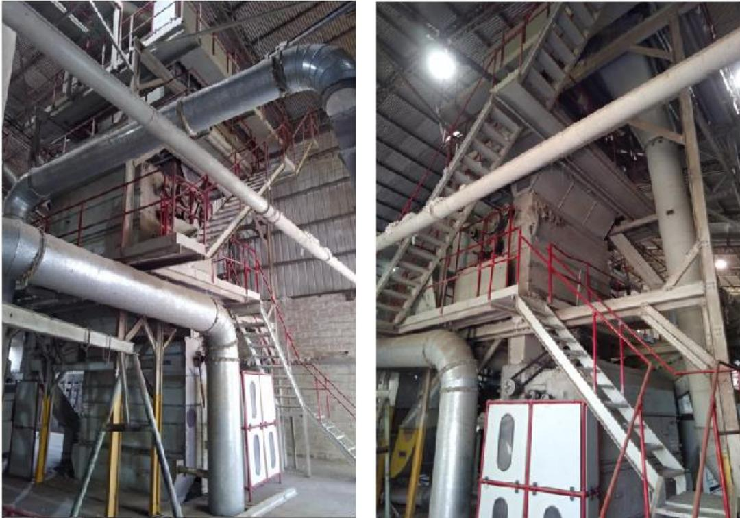
Fotografía 1.4 – Primera etapa de limpieza y extracción de materias extrañas. Las máquinas que las conforman serán nombradas en orden desde la parte superior hasta la inferior: Limpiador inclinado de cilindros, Máquina de hiervas y palos (Stripper) y Máquina separadora de basuras finas (Despalillador y Descascarador).
