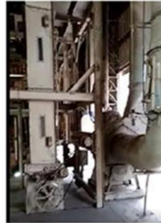
Fotografía 1.3 – Depósito de compensación de control de alimentación y descarga de algodón.
