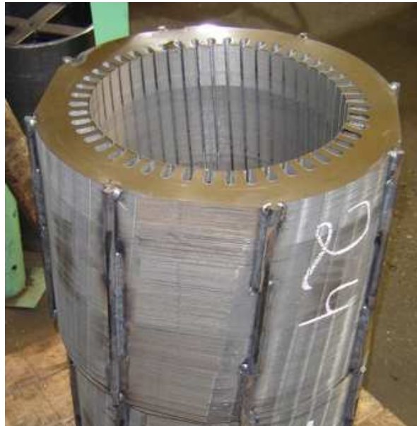
Figura 2. Estator de un generador sincrónico con sus ranuras sesgadas (Cortesía DBT S. A.)
