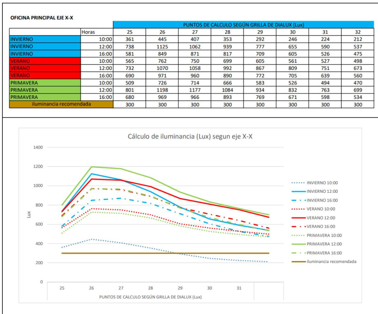
**Figura 33. Niveles Y Curvas de iluminancias en las diferentes estaciones y horas del día para el eje X-X OP. Propuesta optimizada. Fuente: Elaboración propia**
