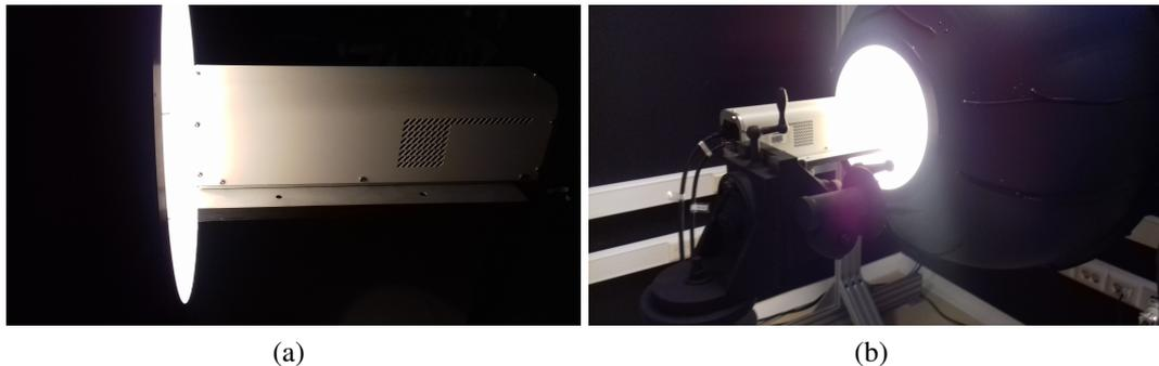
**Fig. 7.1:** Configuración utilizada para capturar imágenes con la cámara VNIR frente a la esfera integradora. (a) Vista lateral; (b) Vista lejana del sistema soporte, cámara y esfera.
