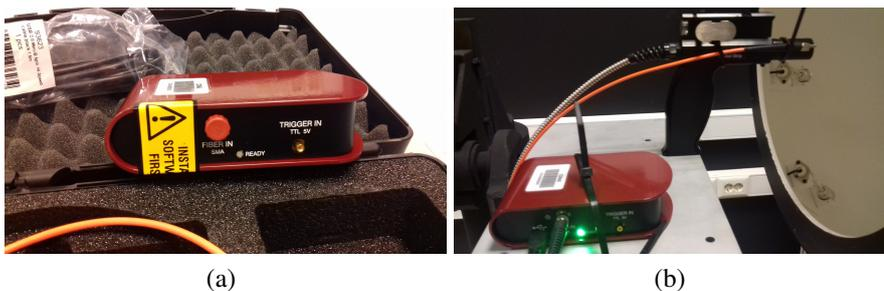
**Fig. 4.3:** Espectrómetro CCS200. (a) Espectrómetro recién sacado de su caja; (b) Espectrómetro CCS200 junto al receptor del espectrorradiómetro, frente a la esfera integradora. Puede verse su fibra óptica (cable naranja) precintada al lado del receptor del espectrorradiómetro.
