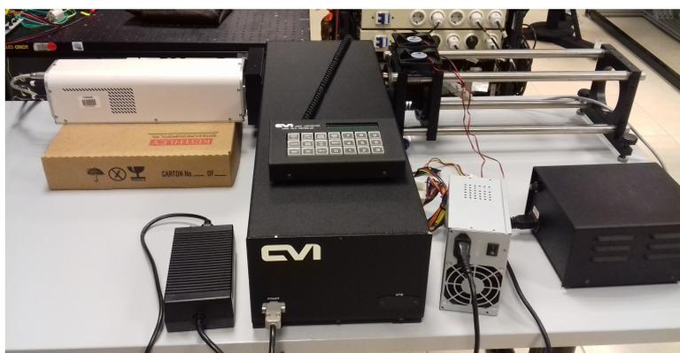
**Fig. 6.6:** Setup de la cámara frente al monocromador.
