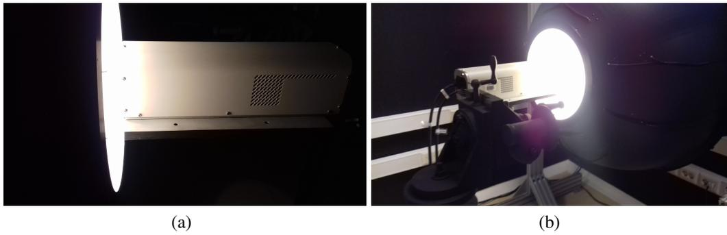
**Fig. 5.3:** Configuración utilizada para capturar imágenes con la cámara VNIR frente a la esfera integradora. (a) Vista lateral; (b) Vista lejana del sistema soporte, cámara y esfera.
