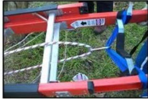
Fotografías de anilla de anclaje enlazada en cabo de poliamida utilizado como línea de vida
