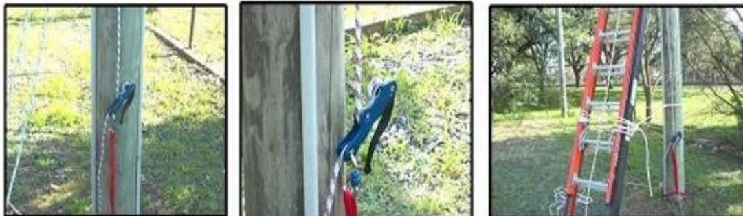
Fotografías descensor doble stop colocado – Sistema de rescate armado
