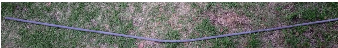
Figura 10: Tubo ensayado a flexión pura normal con deformación permanente
