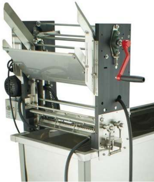
Figura 8: Desoperculadora a cuchillos vibrantes.
