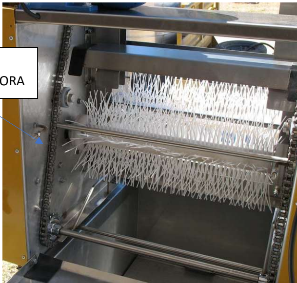
Figura 6: Desoperculadora a rodillos.
