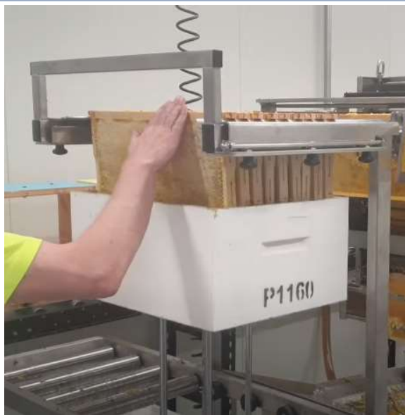
Figura 13: desarmador de cajones con guías escamoteables.
