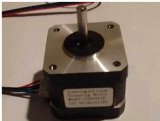
Fig. 1. Motor Nema 17 “Usongshine”
