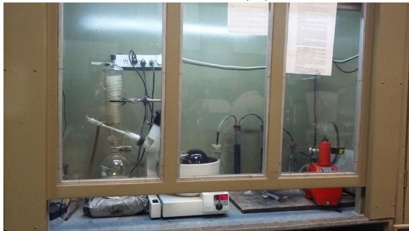
*Figura 6-19. Equipo rotovapor en funcionamiento.
