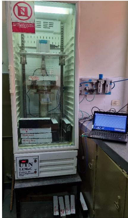
Figura 2-10. Equipo por cargas repetidas implementado
