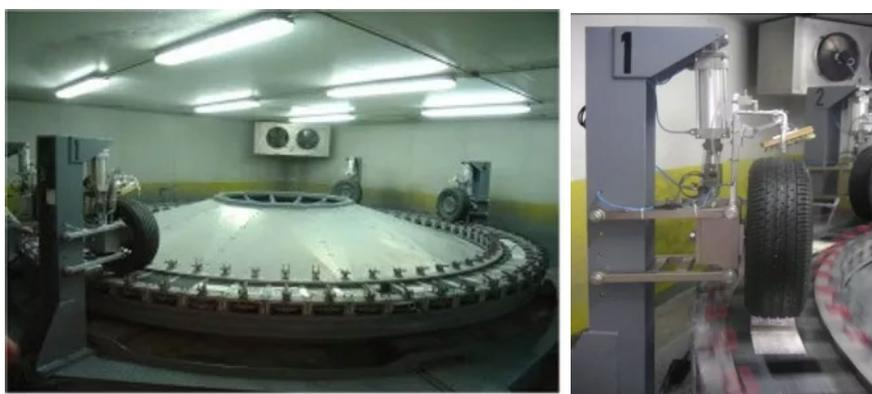
Figura 7-18. Simulador de desgaste "Mesa giratoria"
