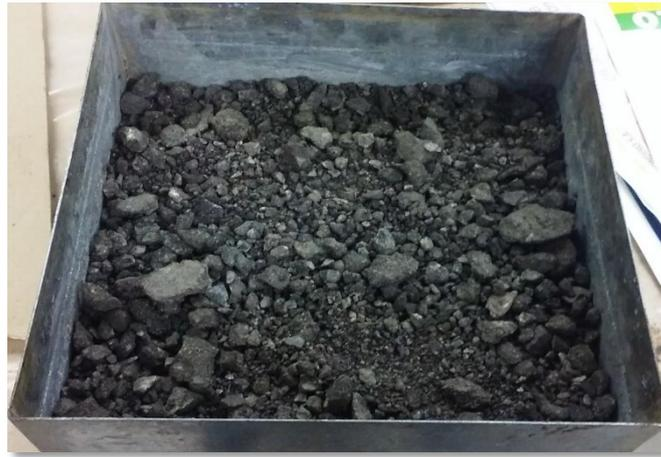
*Figura 6-18. Material RMAP1 seco en estufa a 60° C.
