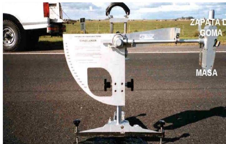
Figura 6-7. Péndulo Ingles de fricción.
