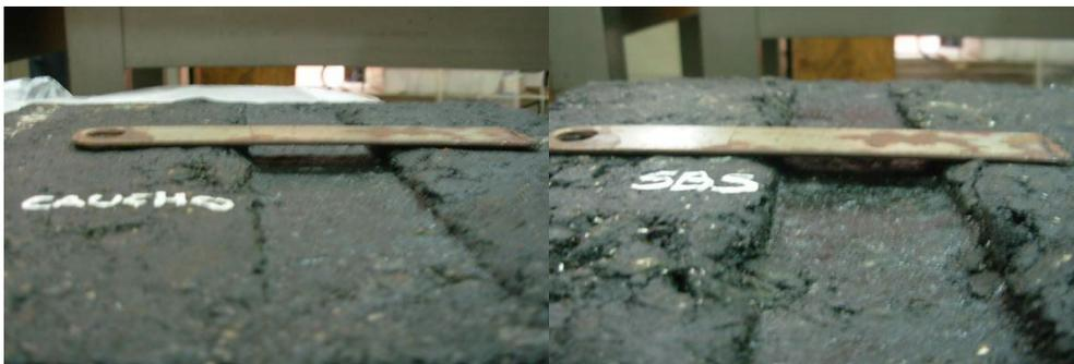
*Figura 2-4. Probetas ensayadas a ahuellamiento
