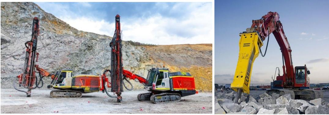
Figura 3-3. a la derecha se observa un martillo neumático, mientras que a la izquierda se observa camión perforador.
