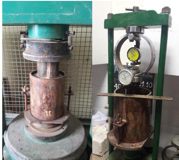
*Figura 1-2. Ensayo Valor Soporte Relativo (VSR)
