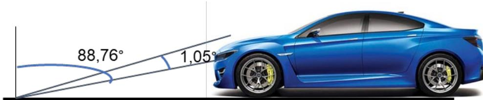
Figura 7-4. Geometría a 30 metros según CIE
