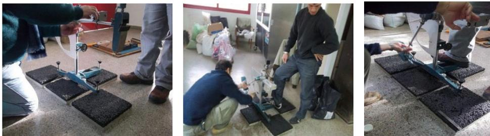
Figura 2-8. Medición de la microtextura con péndulo TRRL
