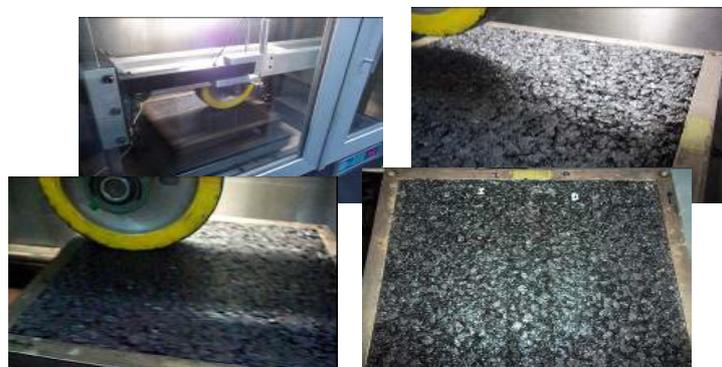
Figura 2-6. Procedimiento de carga con el WTT en las probetas - 3 pasadas una al lado de la otra.
