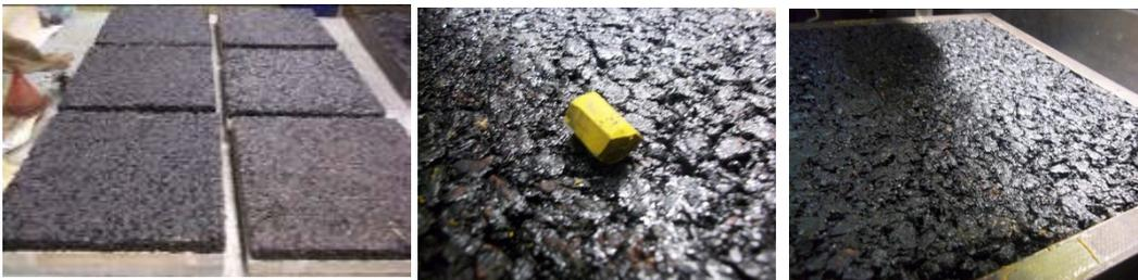
Figura 2-5. Muestras de 30 x 30 de MAC F10 con asfaltos con NFU y SBS
