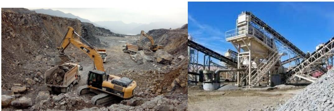
Figura 3-4. a la derecha se observa la planta de trituración y cintas transportadoras. A la izquierda se observa una pala mecánica cargando un camión volcador para el transporte del material hasta la planta de trituración.
