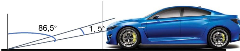
Figura 7-3. Geometría a 15 metros según CIE
