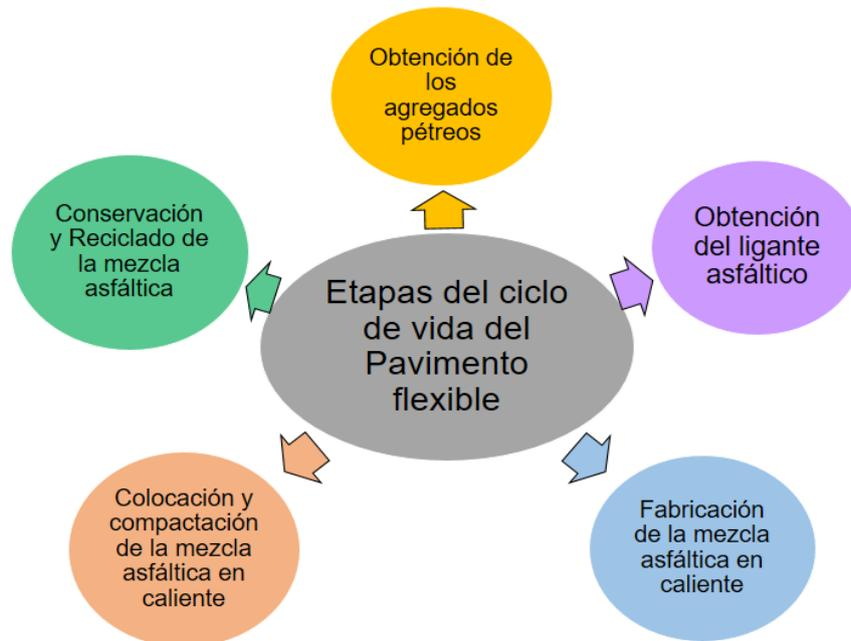
Figura 6-12. Procesos que conforman el ciclo de vida del pavimento flexible
