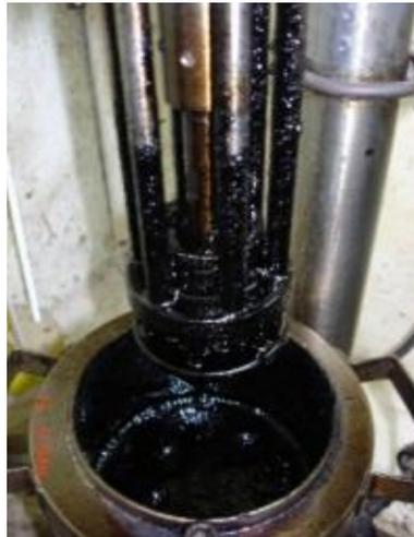
Figura 4-2. Dispersor de asfalto tipo rotor-estator
