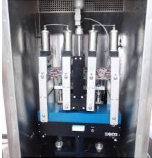
*Figura 1-22. Ensayo de viga de fatiga de cuatro puntos.*
