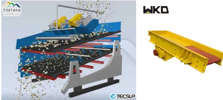
Figura 3-5. a la derecha se observa un alimentador. A la izquierda se observa una zaranda.
