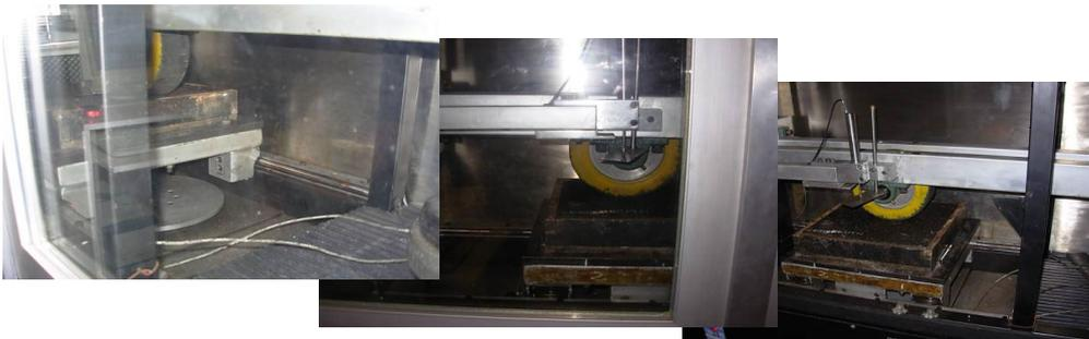
*Figura 2-3. Equipo medición de ahuellamiento
