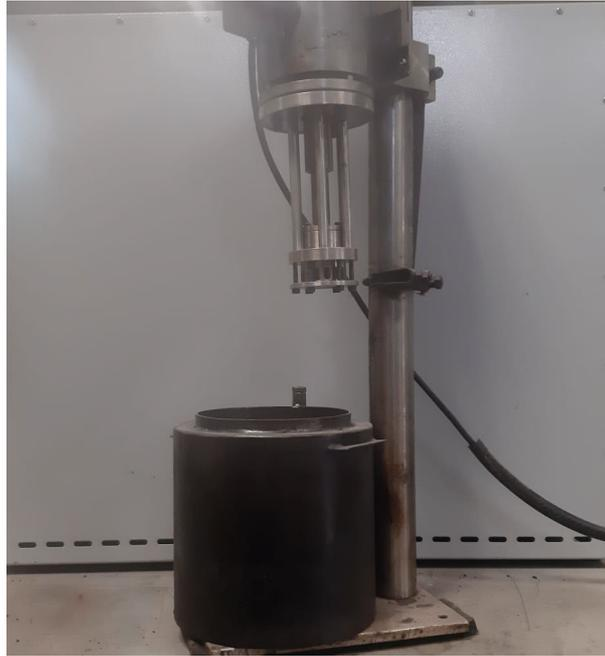
*Figura 1-20. Dispensador de altas revoluciones para conformar el asfalto caucho.
