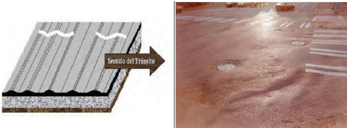
Figura 5-4. Falla del tipo corrugación
