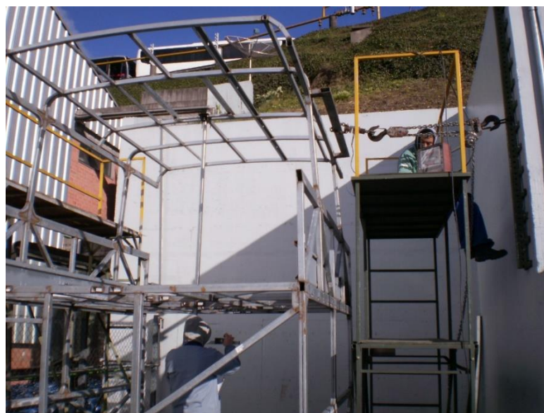
Ilustración 12. Montaje del ensayo de carga lateral
