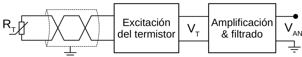
Fig. 5.36: Etapas del circuito de acondicionamiento analógico.
