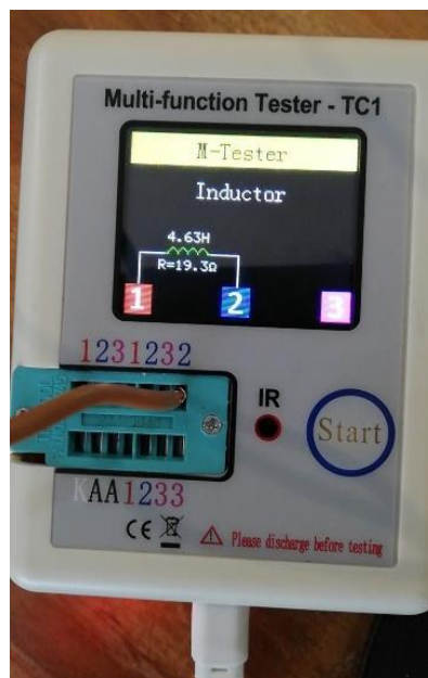
Ilustración 15: Inductancia medida del primario de un transformador
