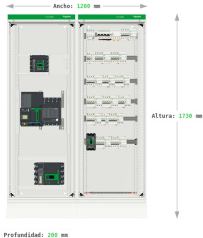
Imagen 120 Modelo Tablero Principal
