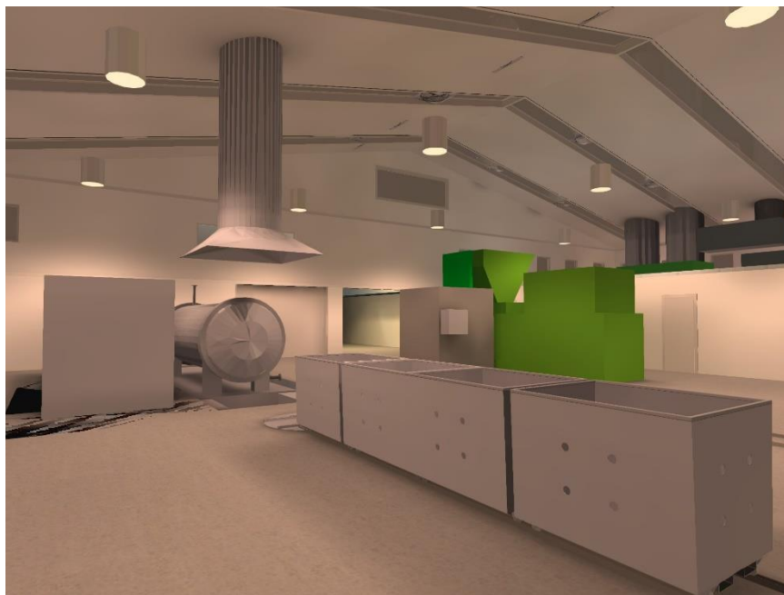
Imagen 46 Disposición de campana de extracción
