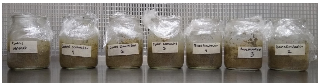
Figura 9. Armado de los sistemas microcosmos empleados en el ensayo de bioestimulación de microorganismos autóctonos.
