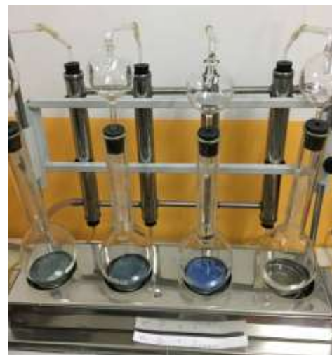
Fig. 2. Destilación por arrastre de vapor en la determinación de nitrógeno total Kjeldahl.
