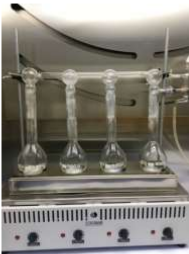
Fig. 1. Digestión de muestra de compost \text{H}_2\text{SO}_4 y ácido salicílico
