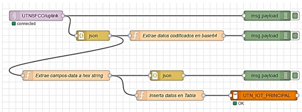
Figura 5: Flujos NodeRED para recibir el payload MQTT desde el gateway, separar e insertar datos en la tabla de la base de datos UTN\_IOT\_PRINCIPAL.
