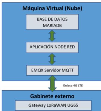
Figura 4. Esquema de los componentes de software.
