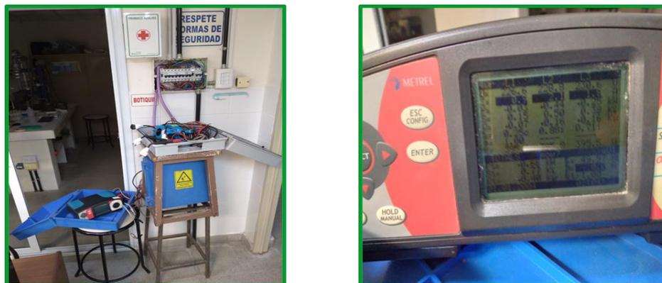
Fig. 1. Funcionamiento del analizador de redes Metrel.
