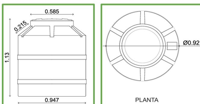
Fig. 2. Dimensiones del tanque.
