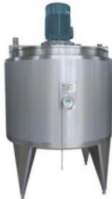
**Ilustración 28 - Tanques de emulsión.**
