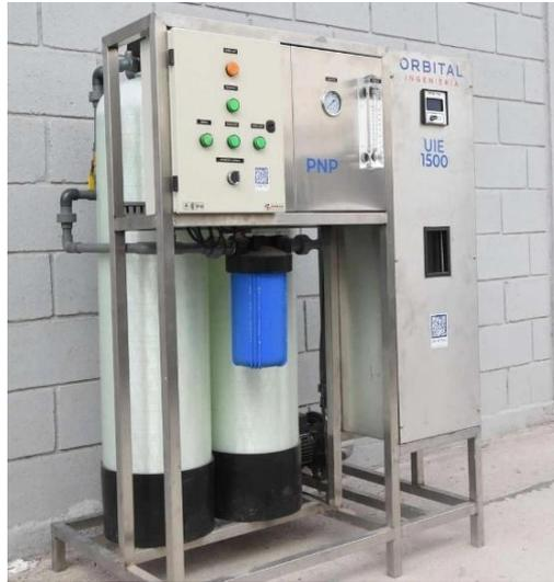
Ilustración 36 - Planta potabilizadora compacta.
