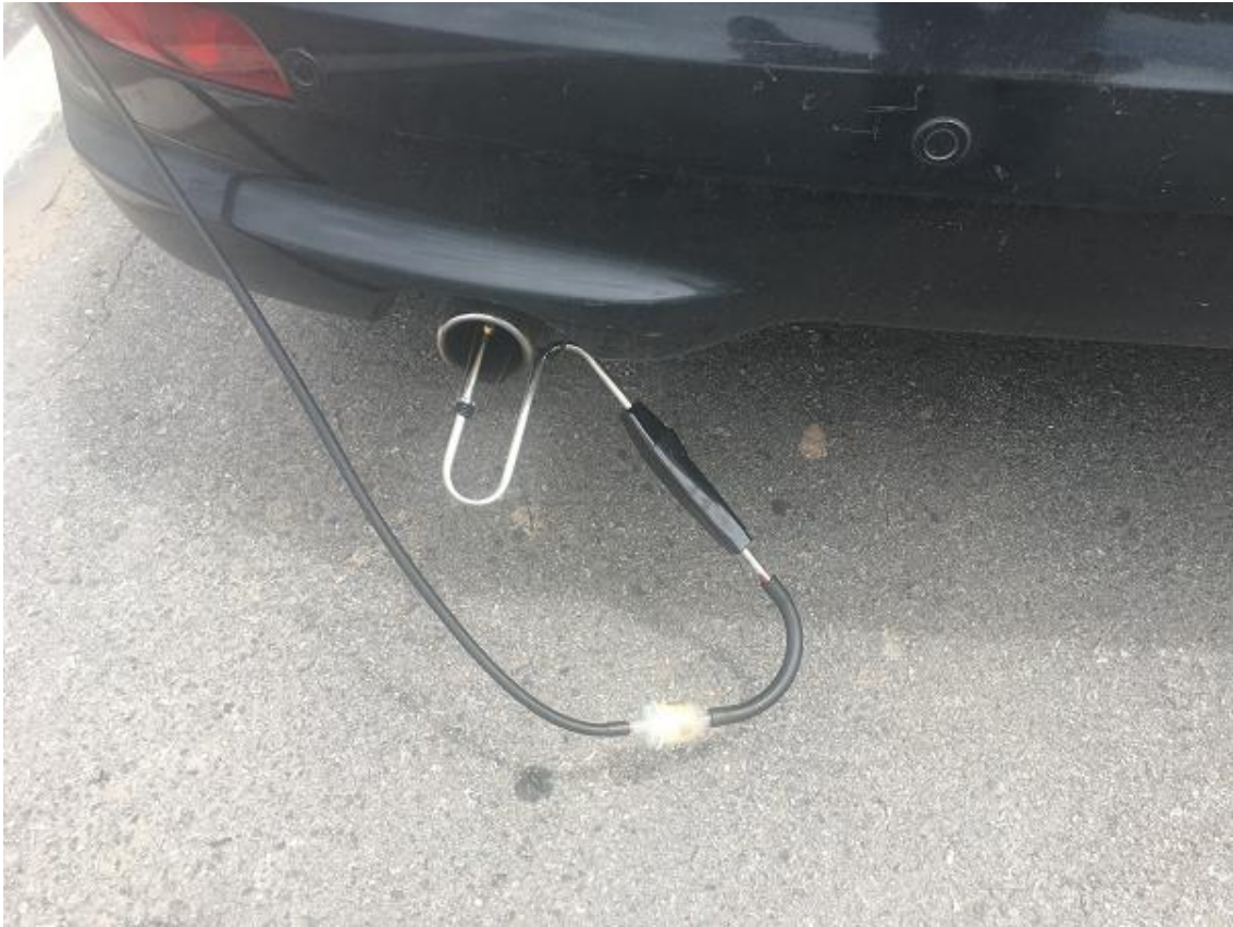
Figura 27: Instrumentación para medición de gases a través de la salida de gases de escape.
