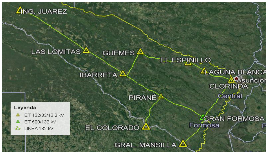
Figura 1. Imagen satelital con identificación de las trazas de las LAT de 132 kV que conforman el SIP de la Provincia de Formosa
