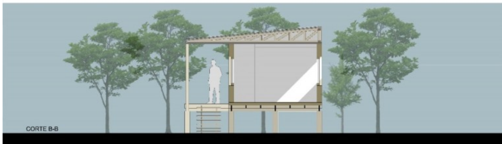
Fig.11.Modulo básico inicial, corte B-B transversal.
