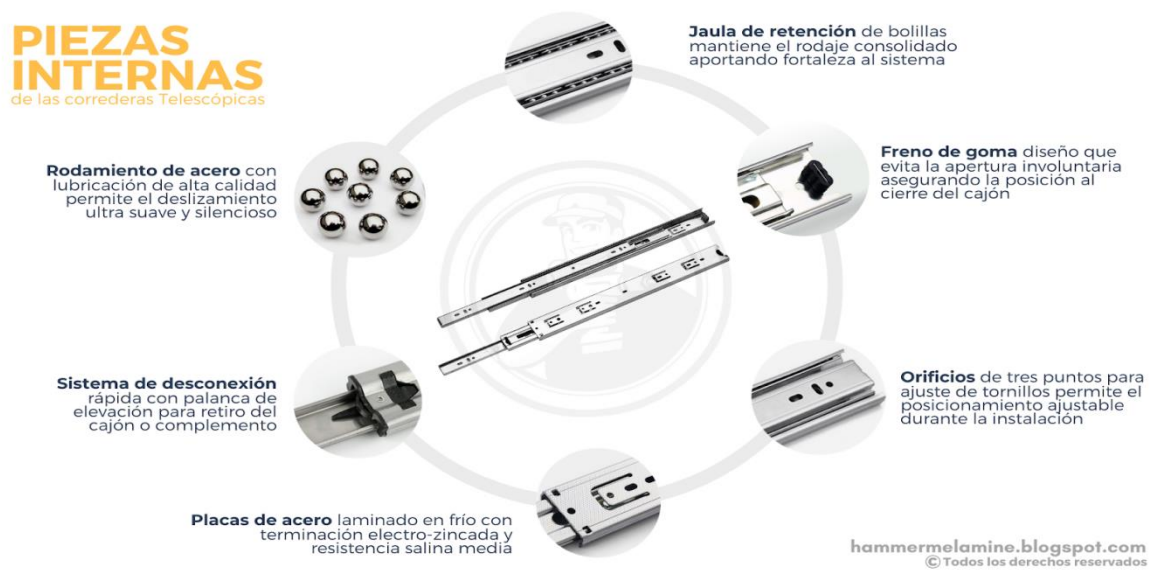
Figura 12 - Componentes de una corredera
