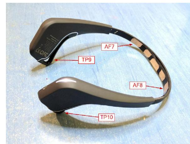
Fig. 2. Ubicación de los electrodos en la interface ABCI.
