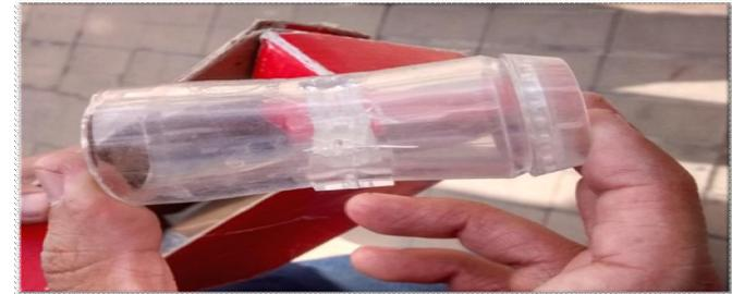
**Fig. 5,** Aspecto físico del sensor de flujo utilizado.
