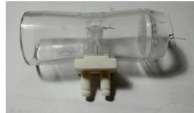
**Fig. 6,** Conector diseñado para el sensor de flujo.
