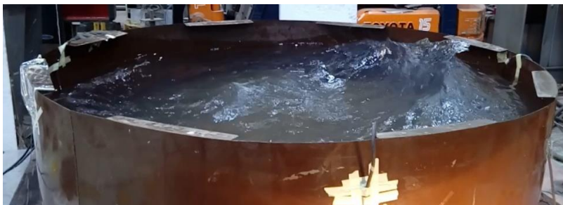
Figura 4. Captura de filmación para registro Kocaeli durante ensayo con base aislada simple curvatura con deslizador de teflón.
