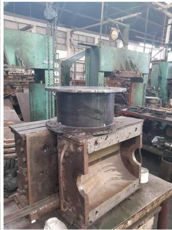
Fig. 6 – Dispositivos desmoldeados y finalizado el proceso de vulcanización
