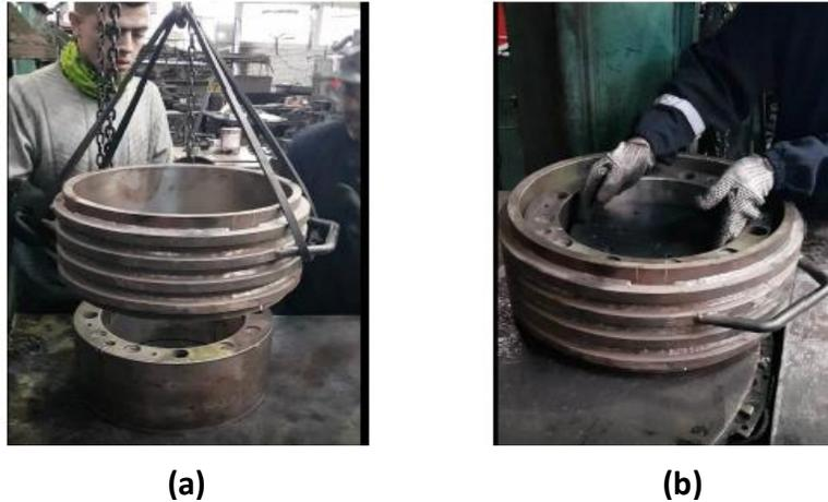
Fig. 3 – (a) Cilindro interior y exterior del molde; (b) cilindros del molde acoplados
