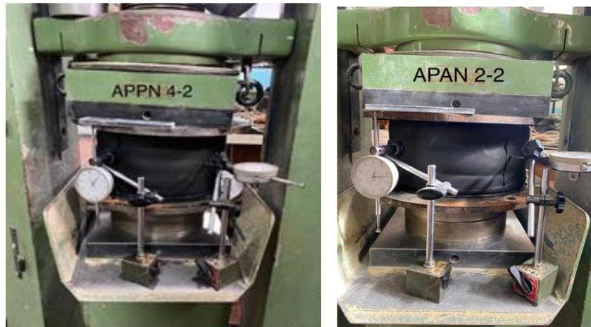
Fig. 8 – Caracterización de los dispositivos a cargas verticales
