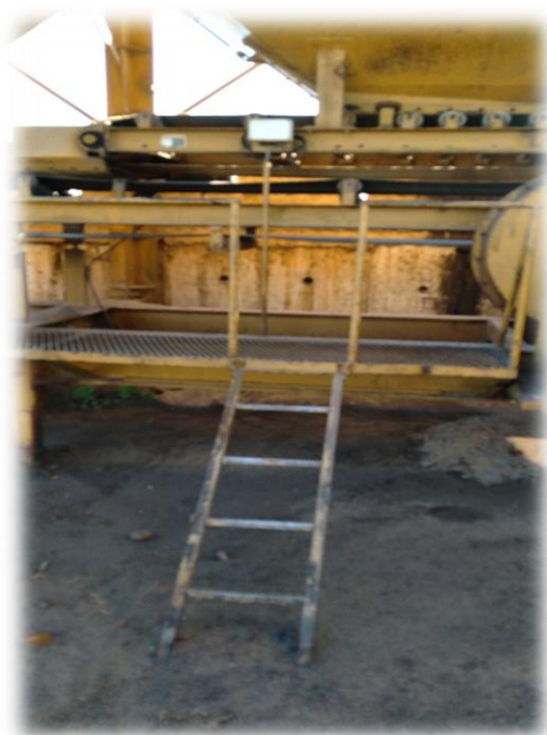
Escalera al ingreso de la cinta transportadora de Áridos. Plataforma de trabajo en sector de tolvas
