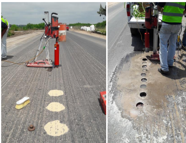
Figura 9. Determinaciones análogas al Ensayo de Parche de Arena efectuadas
