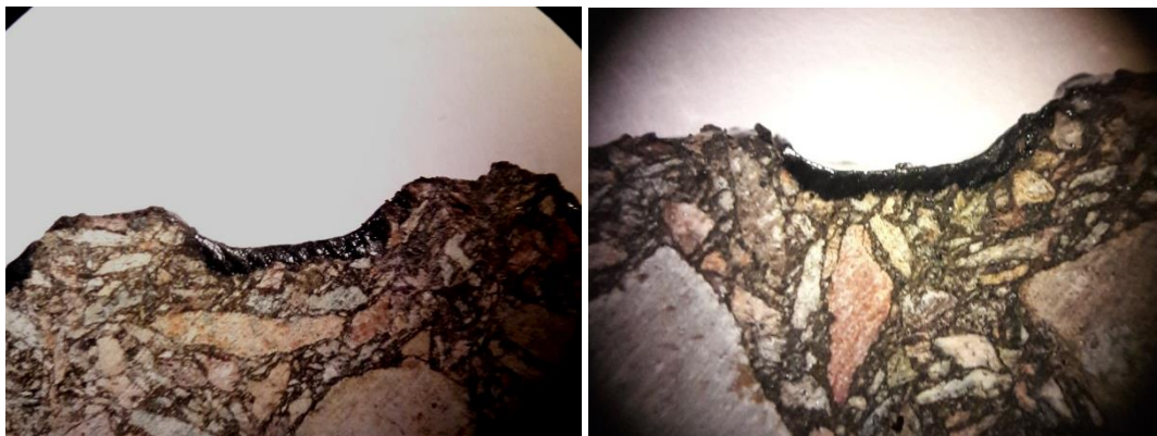
Figura 3. Disposición del riego lograda en laboratorio
