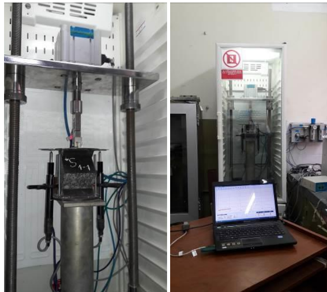
Figura 5. Imágenes durante el ensayo a fatiga de una de las probetas cúbicas
