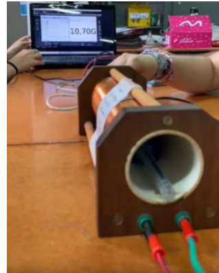
FIGURAS 1 Y 2: MEDICIÓN DE B CON SENSOR DE CAMPO
