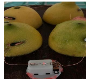
Fig.9. Circuito serie con led.
