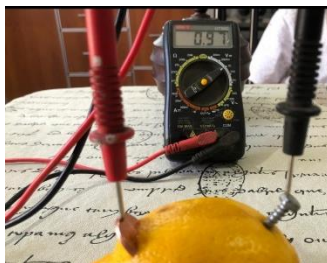
Fig.8 Empleando limón como electrolito
