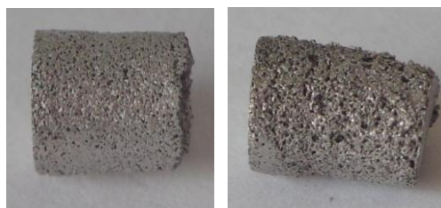
Fig. 1. Compactos de titanio con 50 % y 72 % de porosidad (2x).
