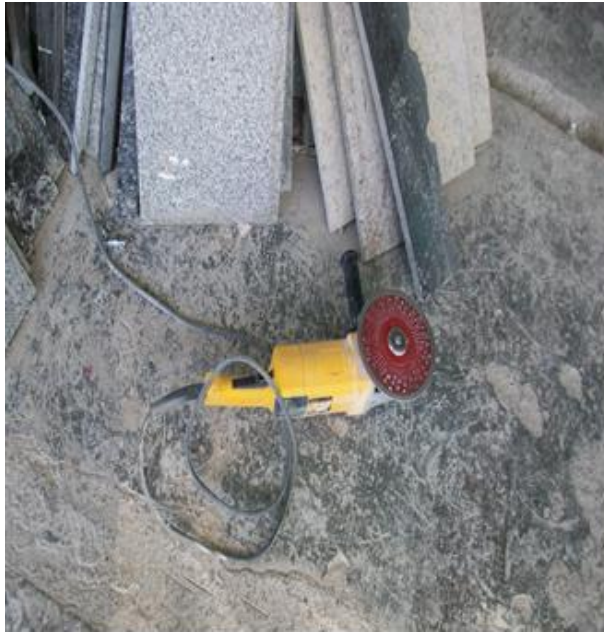
Amoladora de mano (máquina de pulido)
