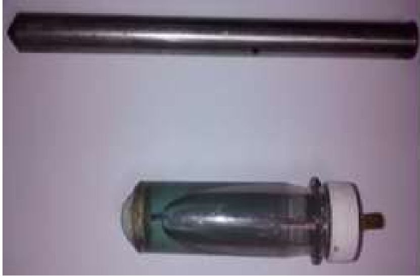
Figura A.8. Electrodo de inyección de corriente y de medición de potencial.
