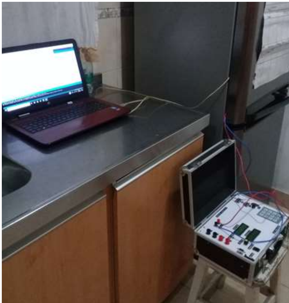
Figura 4.7. Medición de resistividad eléctrica en función de la temperatura.
