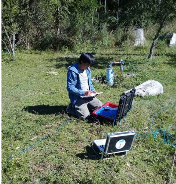
Figura 4.10. Realización del sondeo eléctrico vertical (SEV) paramétrico.
