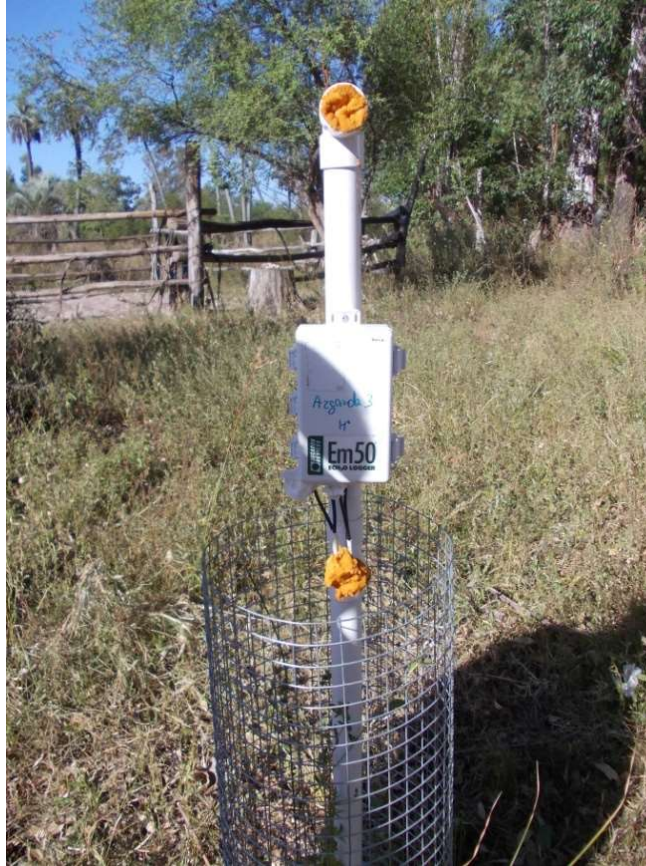
Figura 4.23. Estación de monitoreo continuo de temperatura y humedad de suelo instalada en la cuenca del arroyo Palmar.
