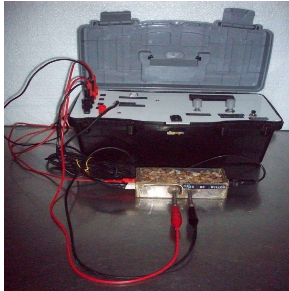
Figura 4.3. Configuración utilizada para la medición de resistividad en laboratorio.
