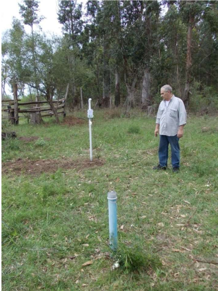
Figura 4.25. Estación de monitoreo de nivel freático.
