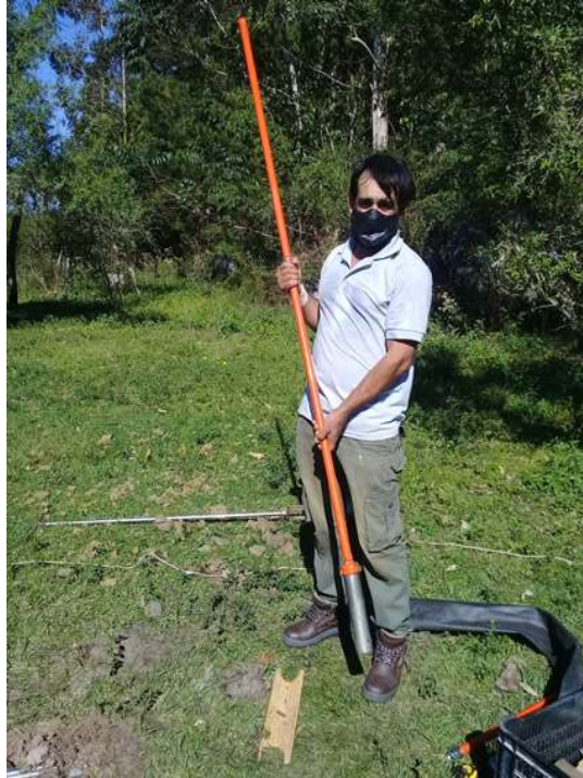
Figura 4.12. Extracción de las muestras en tubos delgados.
