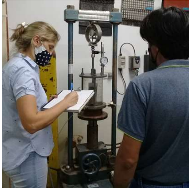
Figura 4.14. Realización de los ensayos triaxiales sobre las muestras extraídas.
