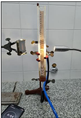
Figura 4. Equipo para evaluación de espuma por burbujeo.
