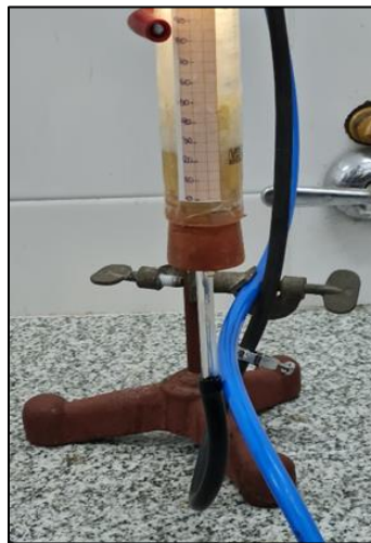
Figura 5. Detalle equipo para evaluación de espuma por burbujeo.
