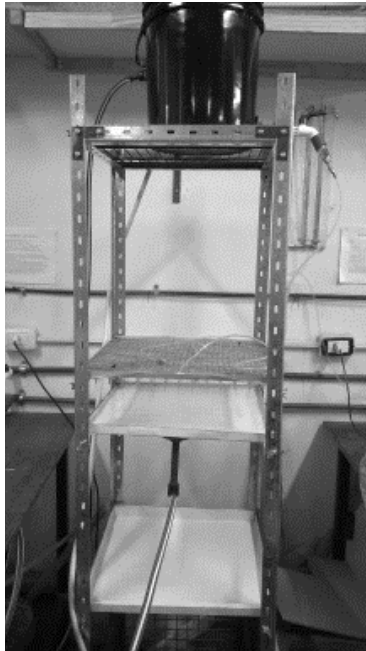
Figura 3. Nuevo simulador de lluvia (izquierda). Esquema del arreglo experimental (derecha)
