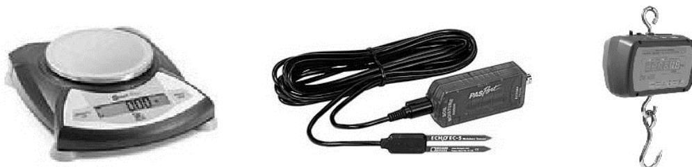
Figura 4. equipamiento de medición utilizado: balanza con comunicación USB (izquierda); sensor de humedad volumétrica de suelo (centro); báscula electrónica 300 kg x 100 g (derecha)
