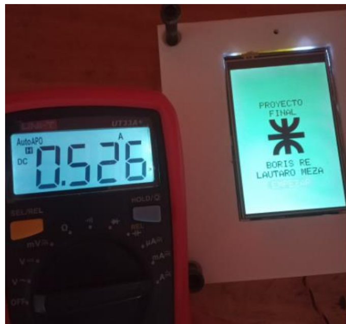
Fig. N°94 -Prueba de consumo eléctrico. [Fuente propia]
