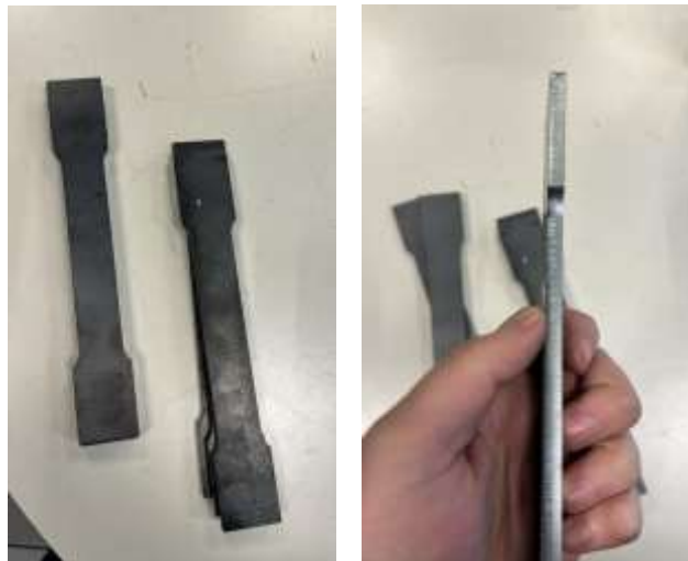
Imagen ilustrativa - Diseño final de probeta ensayada
