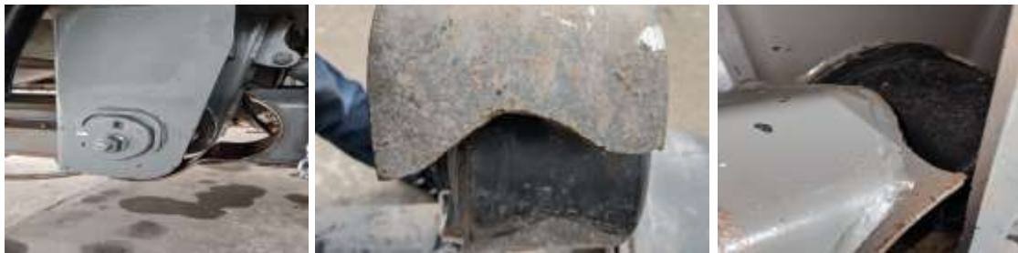
Imágenes ilustrativas - fractura del porta buje
