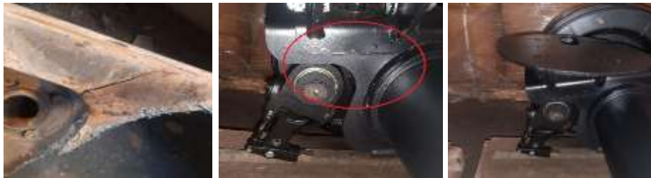
Imágenes ilustrativas - fractura del brazo – zona fuelle de carga
