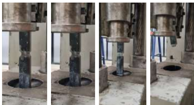
Anexo: Probetas sometidas al ensayo de tracción
