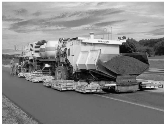
Figura 37.4. Recicladora RX 4500 con paneles infrarrojos (www.wirtgen-group.com)
