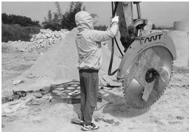
Figura 41.5. Hoja de aserrado de gran diámetro montada en equipo autropulsado
