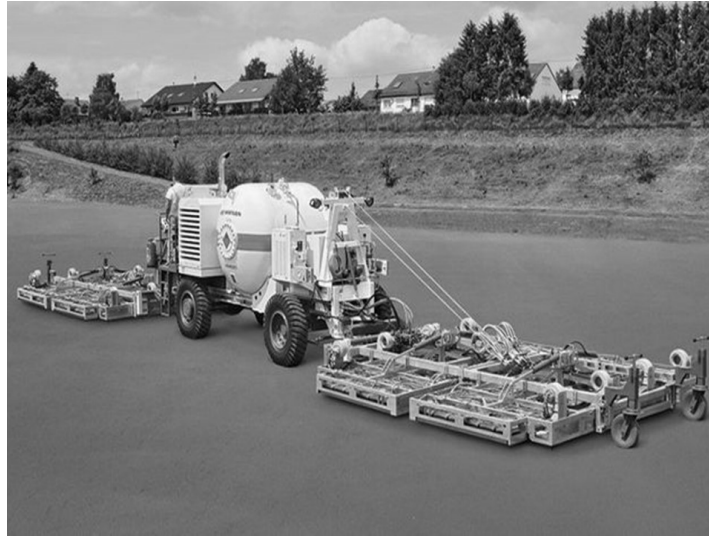
Figura 37.3. Recicladora HM 4500 con paneles infrarrojos (www.wirtgen-group.com)
