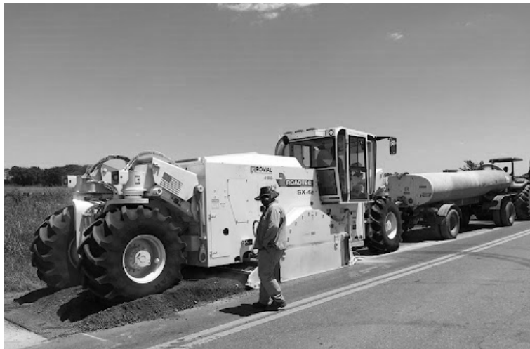
Figura 39.2. Recicladora montada en neumáticos ( rovialesa.com.ar )
