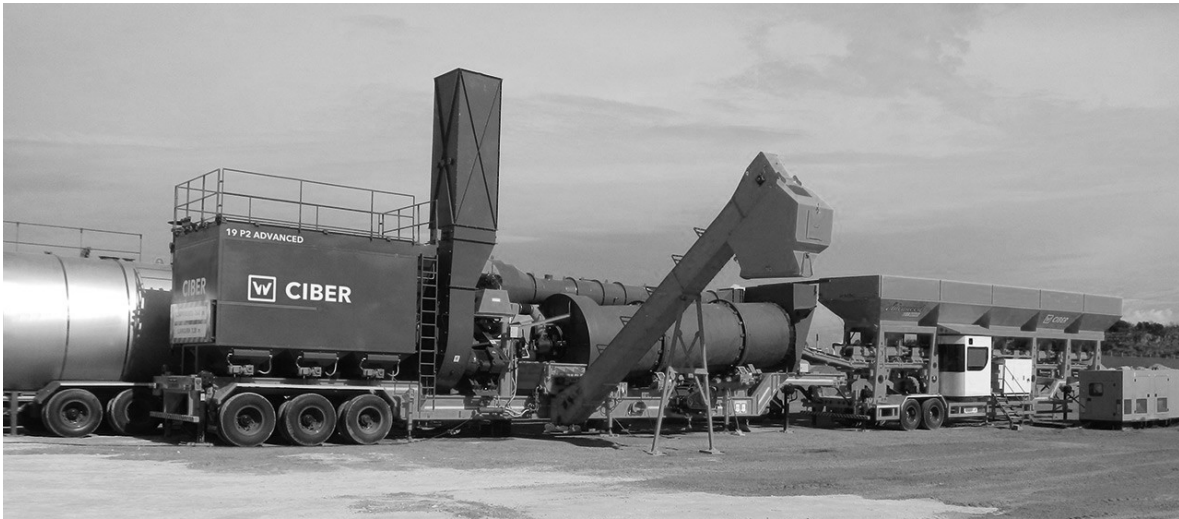
Figura 38.1. Planta de mezcla asfáltica en caliente continua a contraflujo ( www.plantasciber.com.br )
