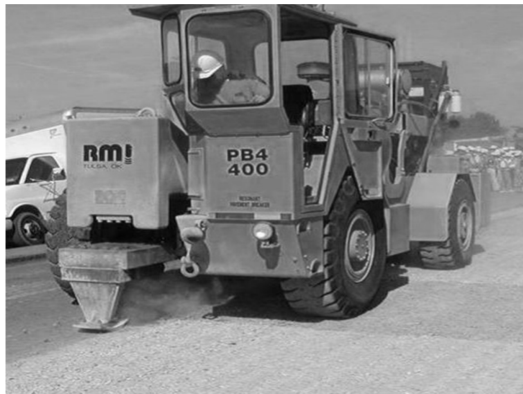
Figura 40.5. Uso del equipo de rubblizing ( https://resonantmachines.com/es_ES/ )
