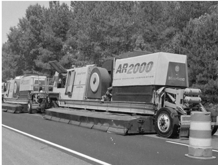
Figura 37.1. Tren de calentamiento de la AR2000 ( www.martec.ca )
