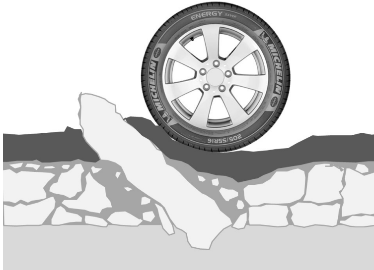
Figura 40.1. Inadecuado tratamiento de losa previo a la colocación de capas de rodamiento
