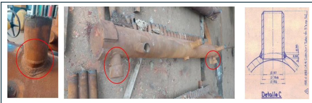
Fig. 6 - Colectores inferiores de paredes laterales, diseño de junta de tubos y colector.
