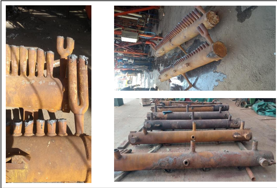
Fig. 5 - Colectores inferiores y superiores de paredes laterales, acopiados para inspección.
