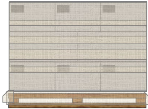
FIG. 4.5 UCL ESTABILIZADA POR RETRACTILADO
