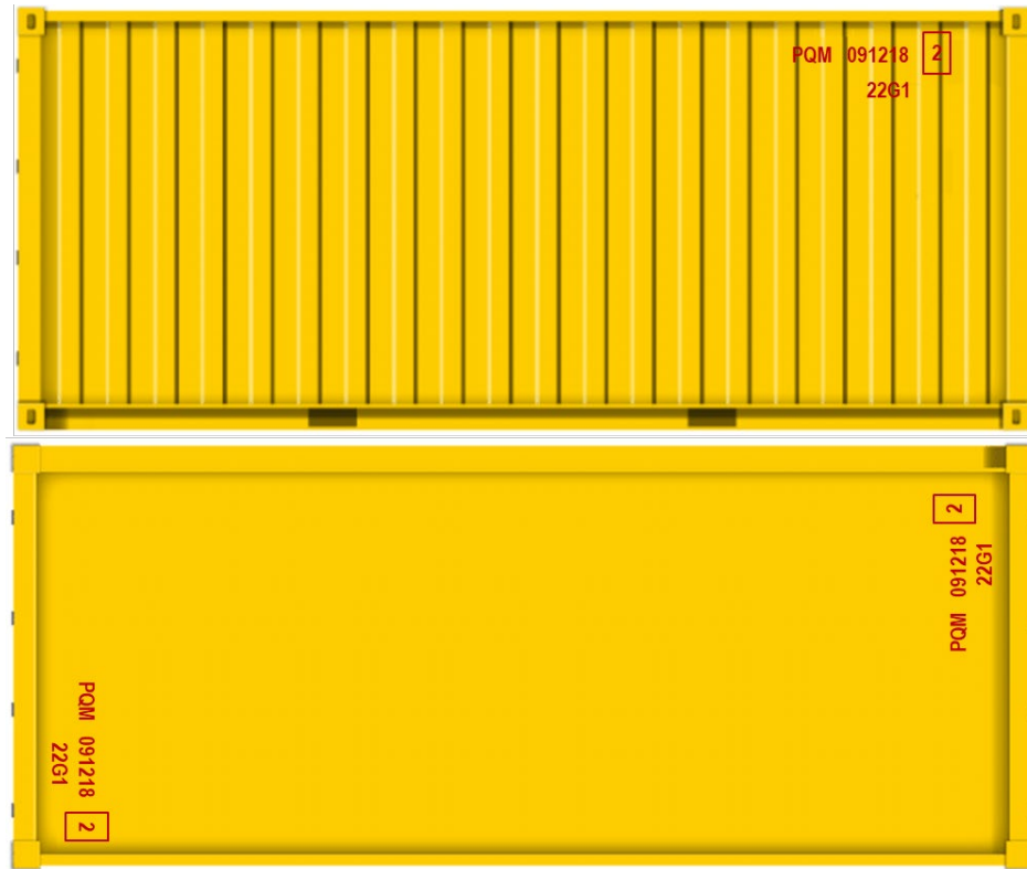
FIG.5.18 IDENTIFICACIONES EN LATERALES Y TECHO
