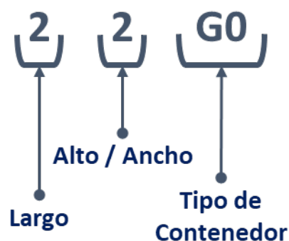
FIG. 5.16 CÓDIGO ISO DE DIMENSIONES Y TIPO
