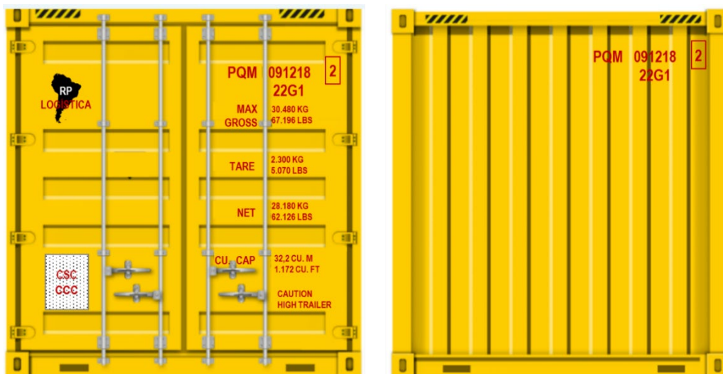
FIG. 5.17 IDENTIFICACIONES EN PANELES FRONTALES, PUERTAS Y FONDO
