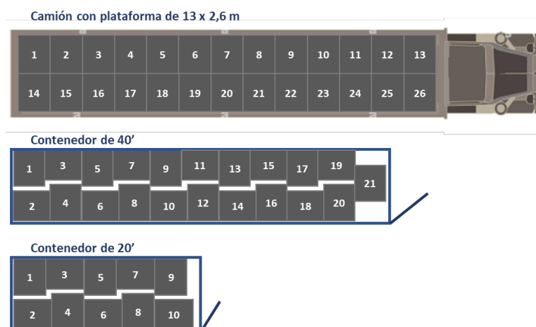
FIG. 4.8 DISTRIBUCIÓN DE PALLETS ARLOG EN UNIDADES DE TRANSPORTE
