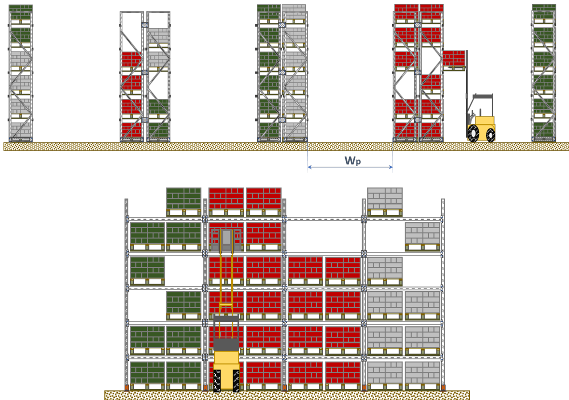
FIG.9.7 SISTEMA DE RACKS ESTANTERÍAS DE BASES FIJAS CON PASILLOS INTERMEDIOS
