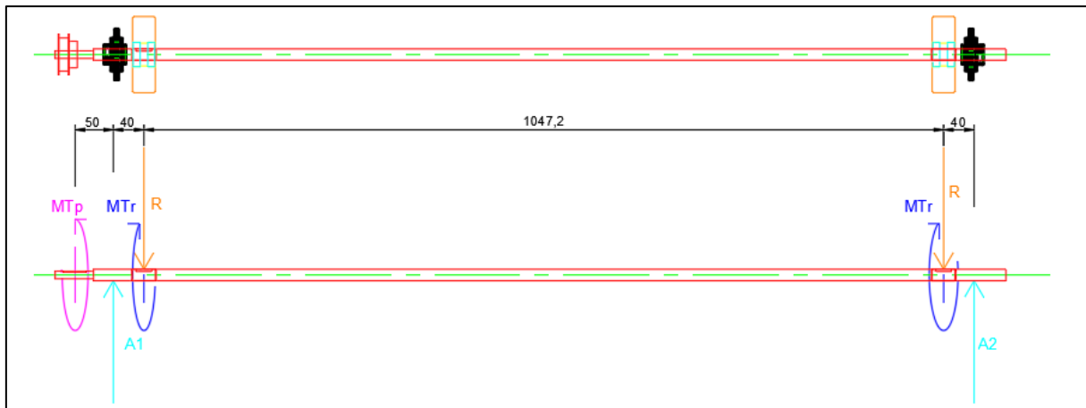
Imagen 51 - Diagrama de fuerzas actuantes sobre el eje motriz
