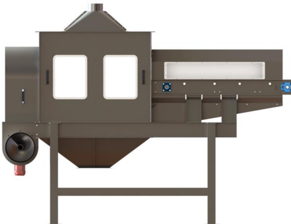
Imagen 68 – Módulos montados al bastidor principal. (Vista lateral)
