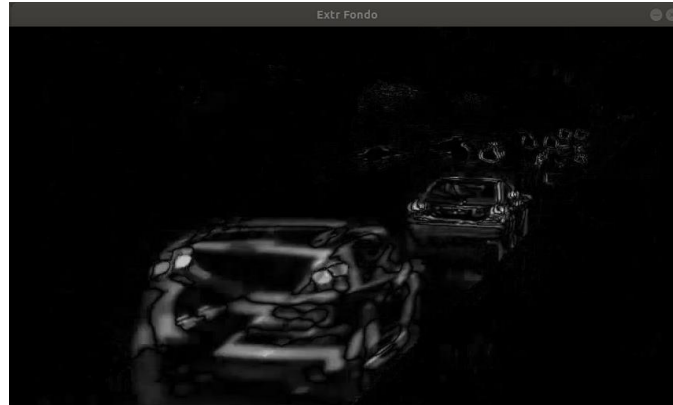
Figura 22 - Imagen luego de una sustracción de fondo utilizando absdiff.
