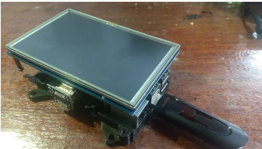
Figura 29 - Display LCD conectado a la Rasperry Pi 3 mediante la interfaz HDMI
