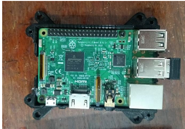
Figura 26 - Hardware de bajos recursos (Raspberry Pi 3)
