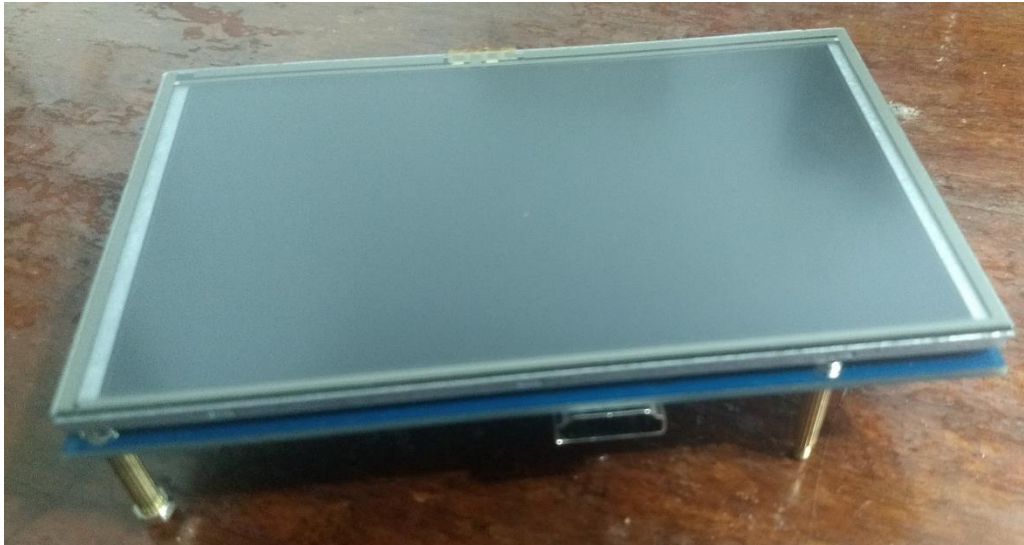
Figura 28 - Display LCD con resolución de 800 x 480 pixeles
