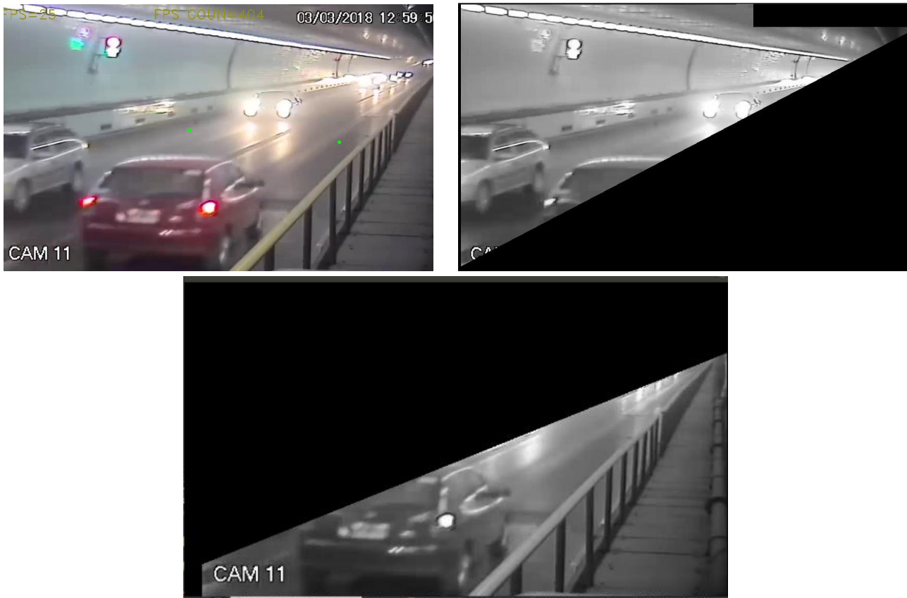
Figura 24 - Se observa el funcionamiento de fillPoly, función utilizada para separar los carriles.
