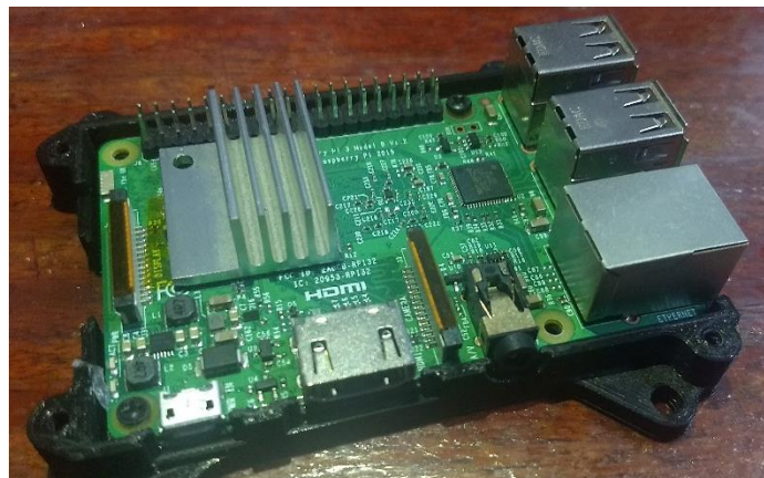
Figura 27 - Disipador de calor sobre el procesador de la RaspBerry Pi 3
