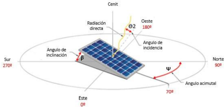
Figura 7, ángulos o variables en consideración para el estudio de captación solar. Fuente: http://somim.org.mx/memorias/memorias2017/articulos/A5_148.pdf
