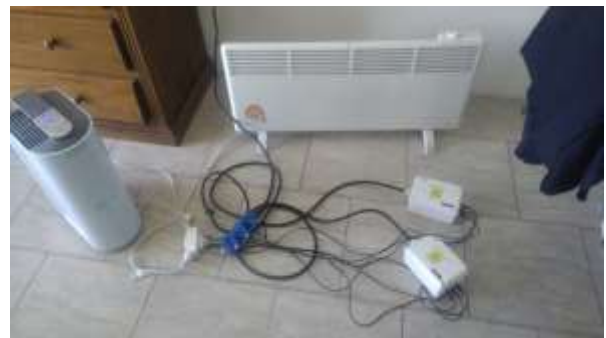
Fig. 17: Calefactor y deshumificador conectados a medidores
