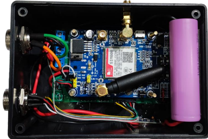
Fig. 48 - Montaje dispositivo de rastreo.
