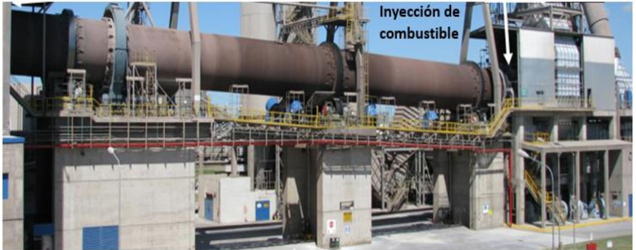
Foto 10 Horno de producción de Clinker, planta de cemento Olavarría (2019)
