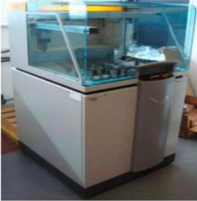
Foto 7 Analizador XRF (2019)
