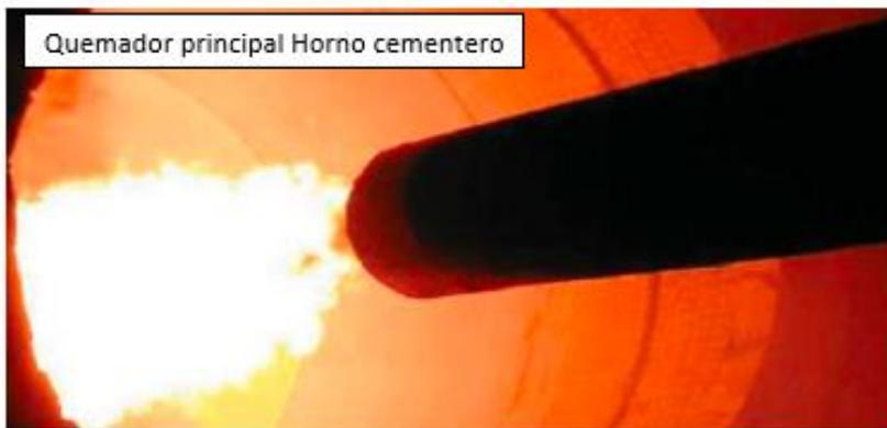
Foto 8 Quemador principal del Horno (2018)
