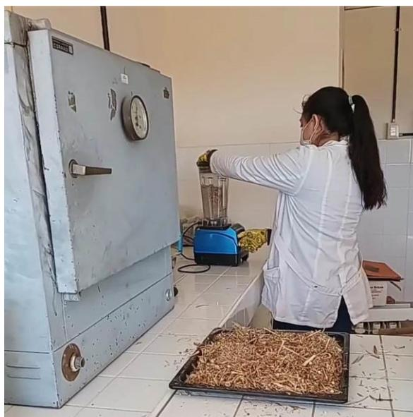
**Figura.** Acondicionamiento de la biomasa a escala laboratorio para su peletización
