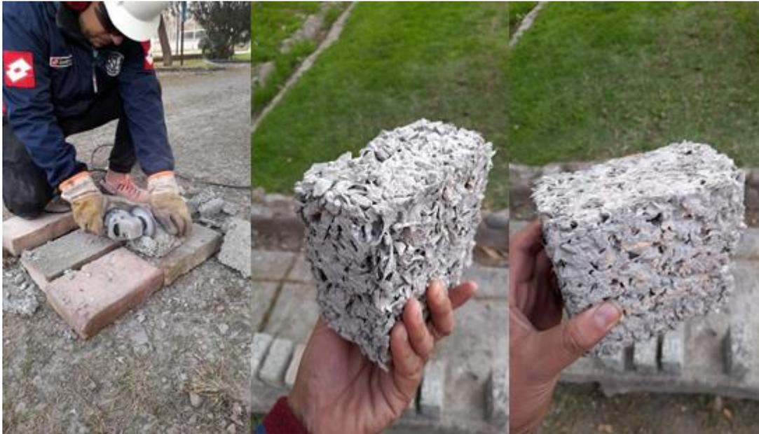
Figura 46: Emparejado de bordes sobre mitades provenientes del ensayo de flexión
