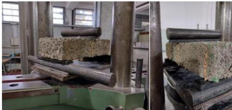
Figura 42: Preparación de muestra en máquina universal
