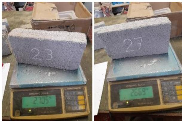
Figura 61: Verificación de masa constante de las muestras
