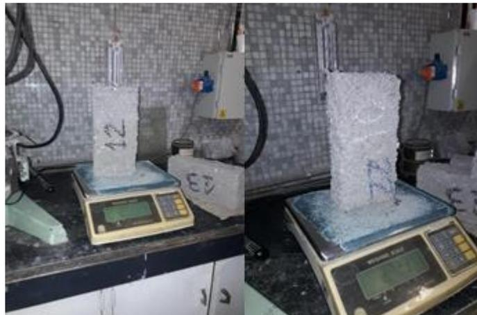
Figura 33: Verificación de masa constante de las muestras
