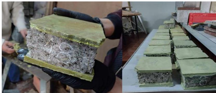
Figura 55: Ladrillos encabezados
