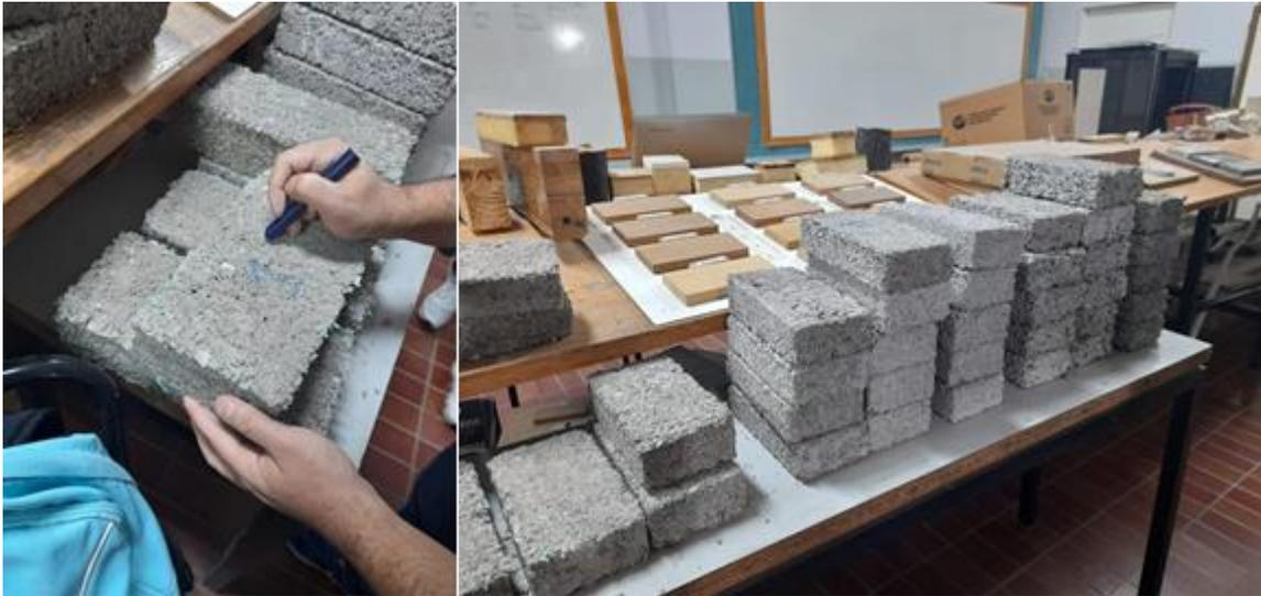
Figura 30: Numeración e identificación de las muestras y posterior orden de las mismas
