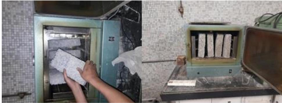
Figura 32: Horno para secado de muestras
