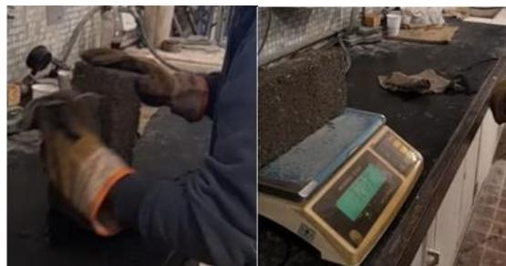
Figura 40: Obtención de la masa saturada
