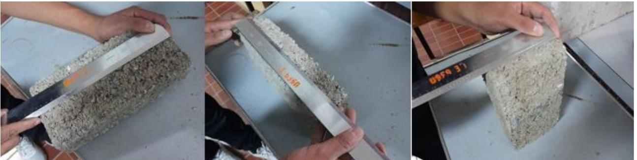
Figura 31: Medición de las dimensiones de los mampuestos
