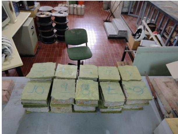
Figura 71: Mampuestos encabezados y enumerados
