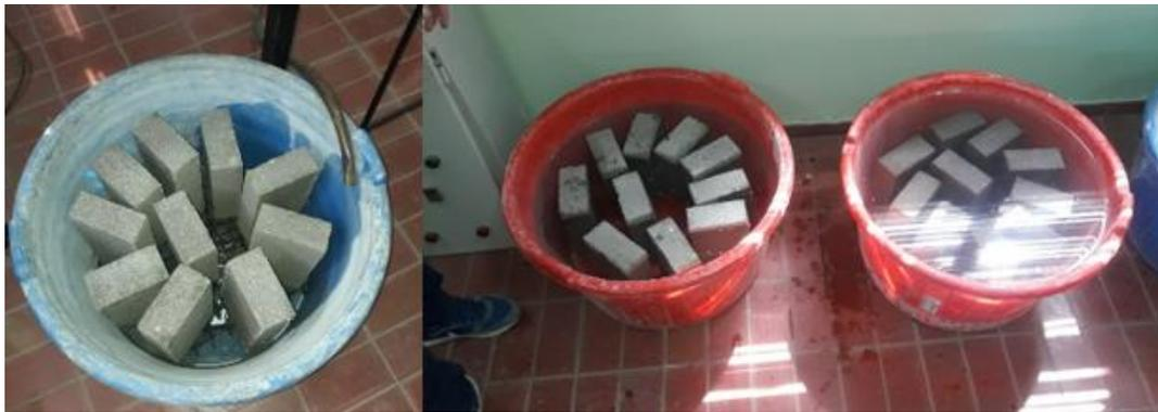
Figura 26: Colocación de mampuestos en tachos para curado
