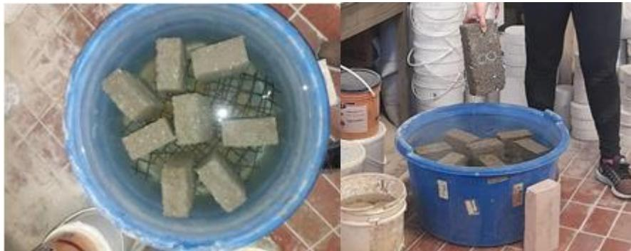
Figura 34: Muestras sumergidas en agua fría
