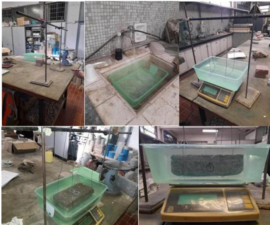
Figura 37: Obtención de la masa sumergida
