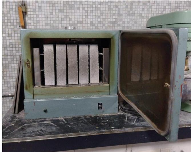
Figura 60: Horno para secado de muestras
