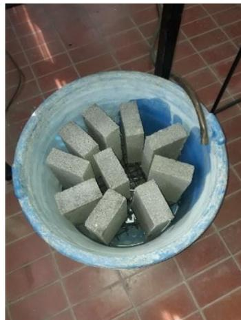
Figura 62: Muestras sumergidas en agua fría
