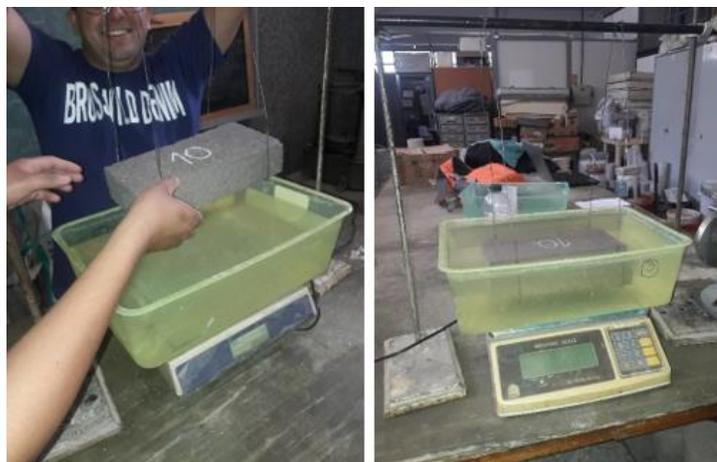
Figura 65: Obtención de la masa sumergida
