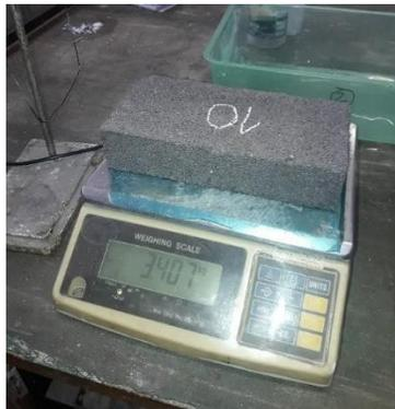
Figura 64: Obtención de la masa saturada
