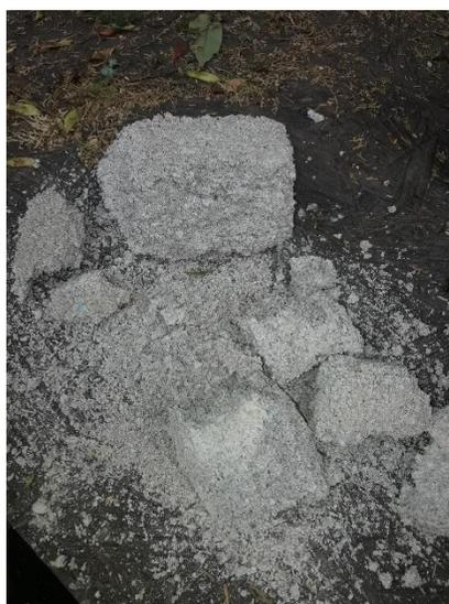
Figura 69: Mampuestos con 45% PET luego de ensayo de flexión
