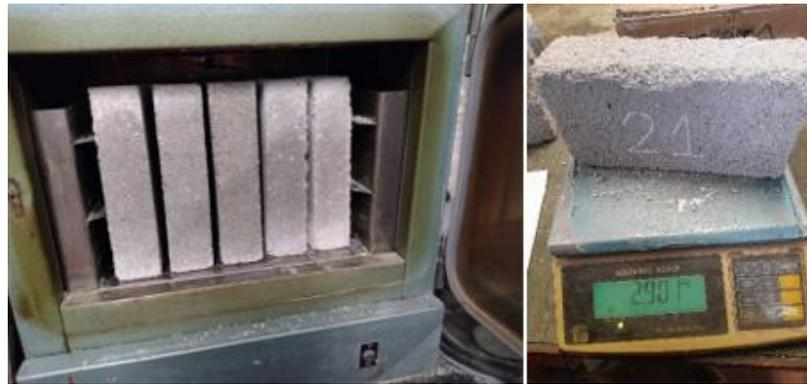
Figura 66: Horno para obtener masa constante
