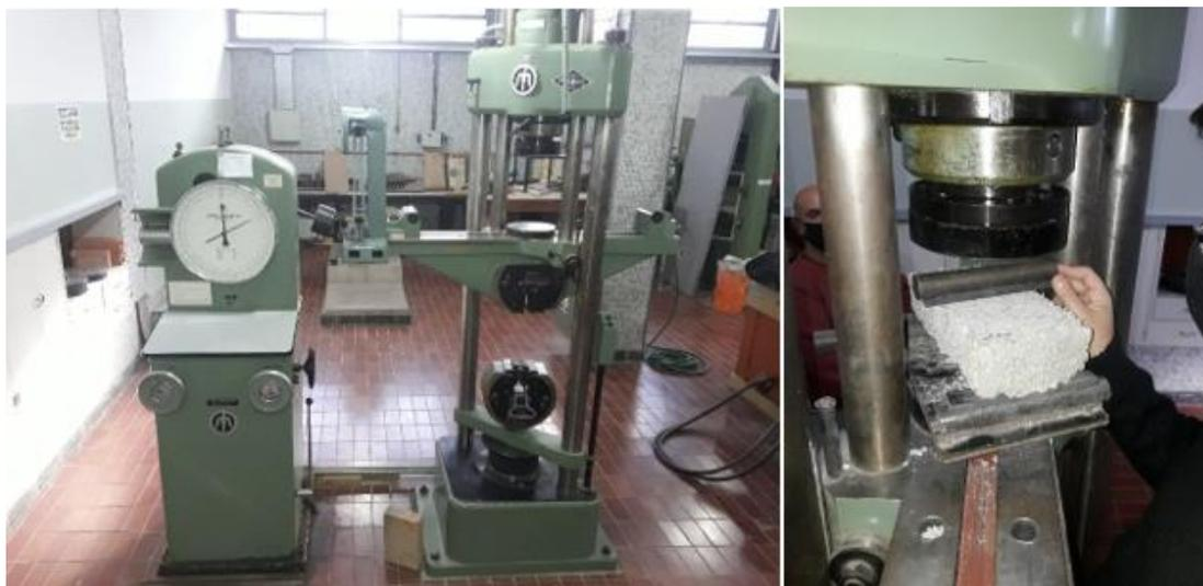
Figura 68: Maquina universal de ensayos – Flexión
