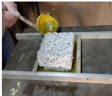
Figura 51: Colocación del ladrillo y aumento de espesor de azufre
