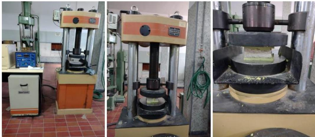
Figura 72: Prensa - Ensayo compresión
