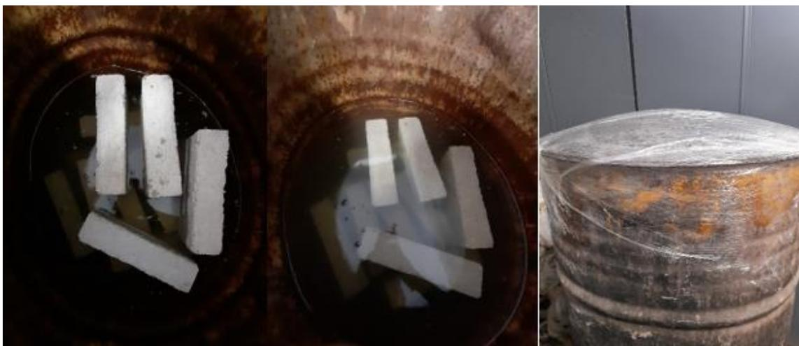
Finalizado este proceso, dejamos enfriar el agua a temperatura ambiente, dejamos escurrir los ladrillos unos minutos, los secamos con un paño y pesamos nuevamente los mampuestos para obtener la masa saturada.
