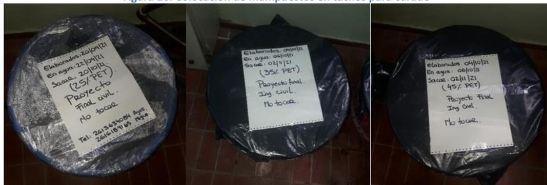
Figura 27: Mampuestos en proceso de curado
