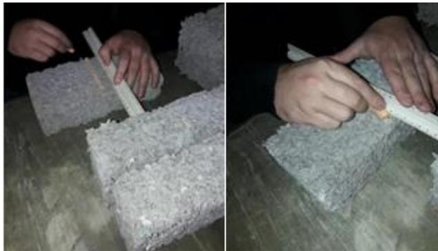
Figura 41: Señalización de los sectores de apoyo para ensayo
