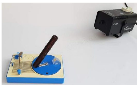
Fig. 1. Tocadiscos con dispositivo para colocación de láser. Al encender el láser y el tocadiscos la rotación forma la generatriz que dependiendo del ángulo de inclinación da lugar a un cuerpo de revolución como el cilindro o el cono. La máquina de humo posibilita una mejor observación del haz de láser. Para la observación de las funciones cónicas, se utiliza una hoja de papel o acetato y se varía el ángulo de la hoja que corta el haz de láser.
