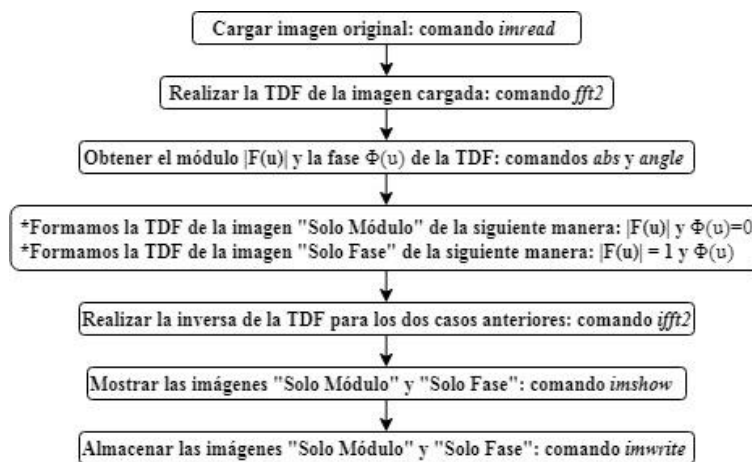
Fig. 6. Etapas del procesamiento realizado en MatLab destacando los comandos utilizados para la obtención de las imágenes “Solo Módulo” y “Solo Fase”.
