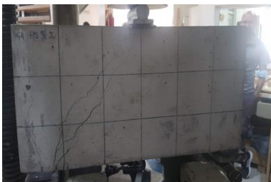
a. VGA de HS con armadura reducida
