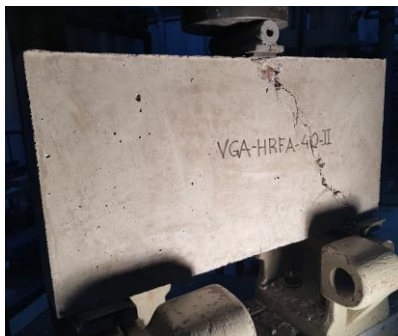
a. VGA de HRFA con 40 kg/m 3 de fibras
