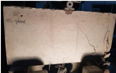
a. VGA de HS con armadura reducida
