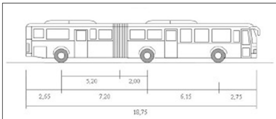
Ilustración 35: Dimensiones de un autobús articulado (Fuente: Internet)
